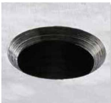
Senkung mit spiralisiertem Kegelsenker
