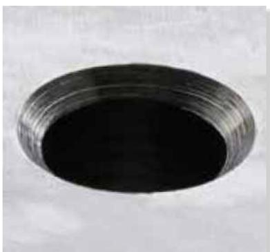
Senkung mit spiralisiertem Kegelsenker
